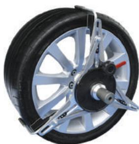
Autocentrante touchless da 13" a 21" autocentrante ad appoggio diretto: non necessita di puntali da inserire fra il cerchio e lo pneumatico. rimane saldamente aggrappata ad esso evitando possibili danneggiamenti al cerchio, soprattutto su quelli più delicati. Un veloce selettore per selezionare i pollici dello pneumatico e un pomolo a ingranaggio per serrare i tre punti di attacco. Sui cerchi in ferro non è necessario togliere i copricerchi.
