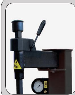
**POSIZIONAMENTO UTENSILE:** Il posizionamento orizzontale dell'utensile si ottiene per mezzo di un volantino filettato. Operando su più ruote delle stesse dimensioni si mantiene la regolazione iniziale. Con il semplice azionamento di una leva si ottiene l'alzata dell'utensile rispetto al cerchio e il bloccaggio verticale dell'albero.
