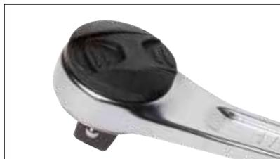
Cricchetto fino a **72 denti**: angolo di ripresa di **5°** per lavori in spazi limitati di manovra. Mantiene la caratteristica di avere un dentello con 17 denti, di cui 11 sempre in presa.
